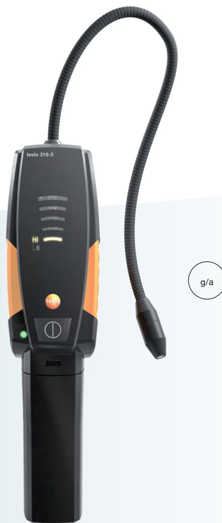
testo 316-3 è un affidabile cercafughe per refrigeranti che dovrebbe essere parte della dotazione di ogni tecnico del freddo. E' in grado di rilevare persino le più piccole fughe grazie alla sua elevata sensibilità di 4 g/a, ed è conforme alle normative SAE J1627 e EN14624.
